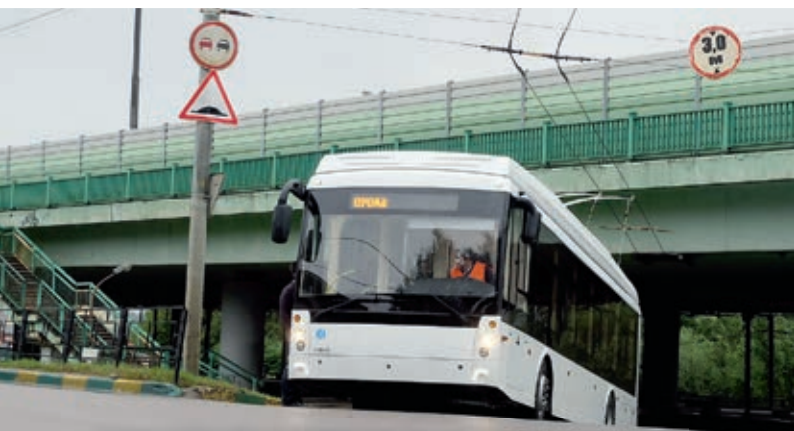
Электробус «Тролза-5265-03» благодаря динамической подзарядке от КС не теряет скоростных характеристик на подъёмах
